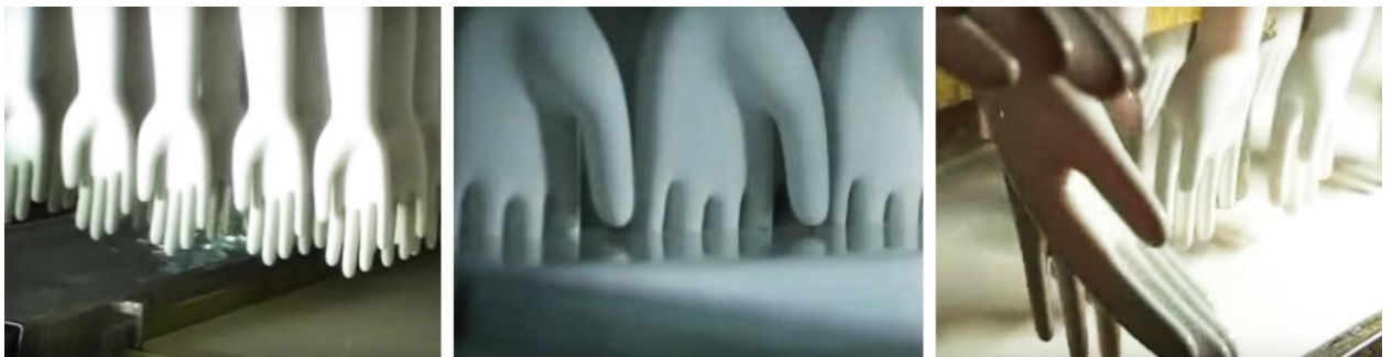
Рис. П.2.16 – Бесшовное формообразование перчаток. Метод формования путем опускания заготовки в жидкий латекс, 2006 г.
