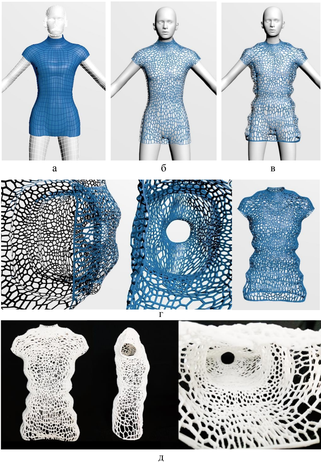
Рис. П.3.9 – Практическая апробация дизайн-проектирования монолитной формы одежды на основе FDM-печати. Модель №1: (а) оболочка-примитив с заданной геометрией сетки; (б) выполнение перфораций (Bevel); (в) модификация формы (FreeForm); (г) утолщение формы (Shell); (д) напечатанная модель на 3D-принтере в масштабе 1:2,5
